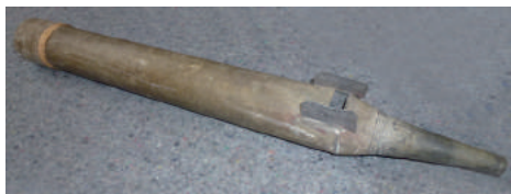
Grootste pijp Roerfluit 4' (hoofdwerk): pijp uit 1638 met door Verhofstadt vervaardigde voet
